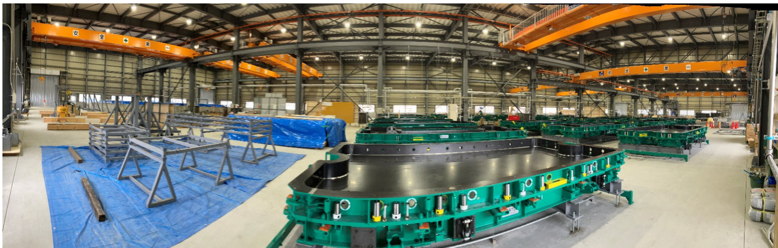
北海道新幹線、倶知安軌道スラブ製作運搬 スラブ製作工場（2025年3月稼働）
