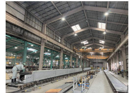
工場でのプレキャスト製品製造状況
